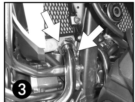
Die Originalschraube vorne an der Motoraufhängung und die Motorschutzplatte mit Halterung entfernen. Die beiden Schrauben der Rahmenbefestigung rechts hinten entfernen (siehe Schritt 4). Schrauben entfallen. Weiter entfallen die Originalschrauben der Motoraufhängung, die Halterung und deren Schrauben.
