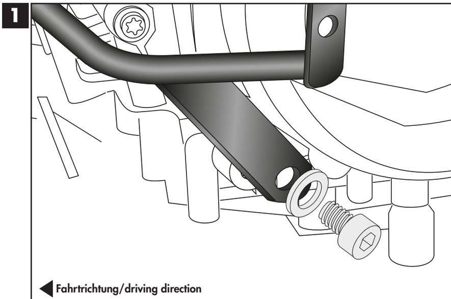
**Montage Motorschutzbügel rechts oben:**
