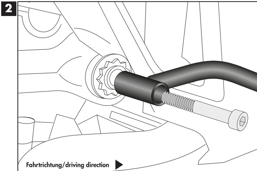
**Montage Motorschutzbügel rechts unten:**
