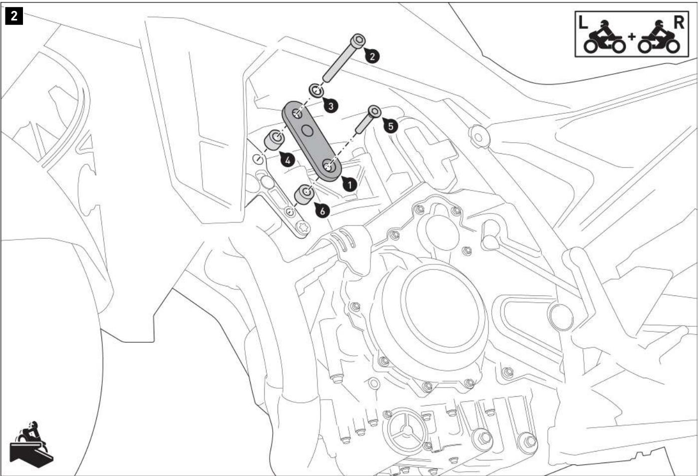
Vissez les supports de fixation (1) sur le véhicule.
