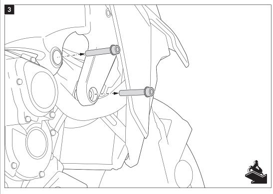
Entfernen Sie die original Motorhalteschrauben und Muttern auf der **rechten** Fahrzeugseite.
