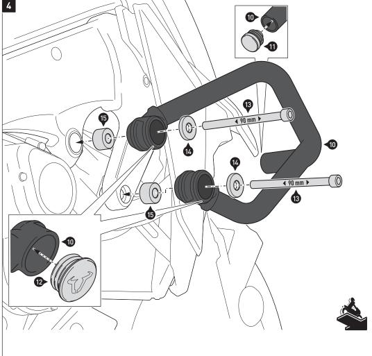
Setzen Sie den Kunststoffstopfen (11) in den Sturzbügel (10) ein.
