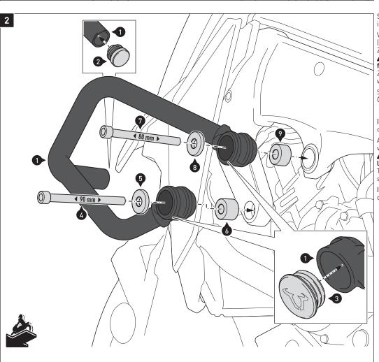
Setzen Sie den Kunststoffstopfen (2) in den Sturzbügel (1) ein.
