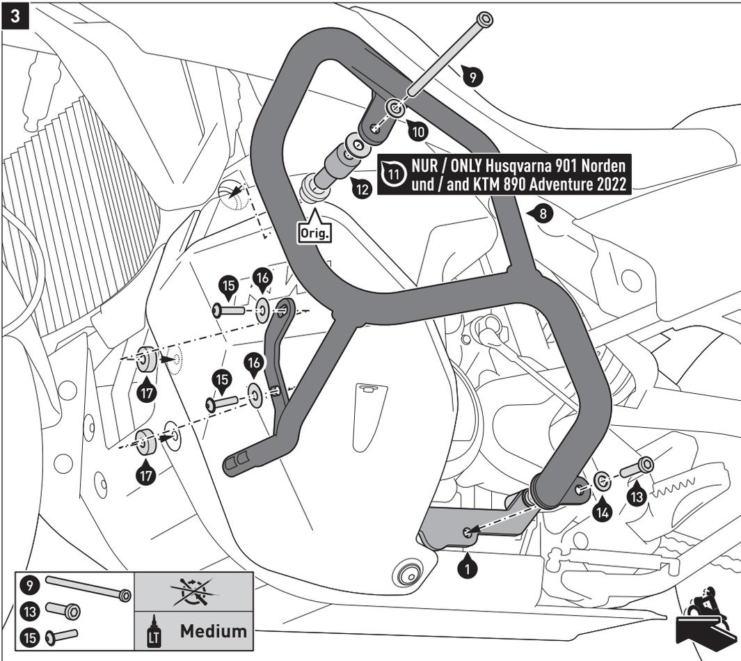
Verschrauben Sie den Sturzbügel (8) am Fahrzeug und dem Anbaublech (1).
