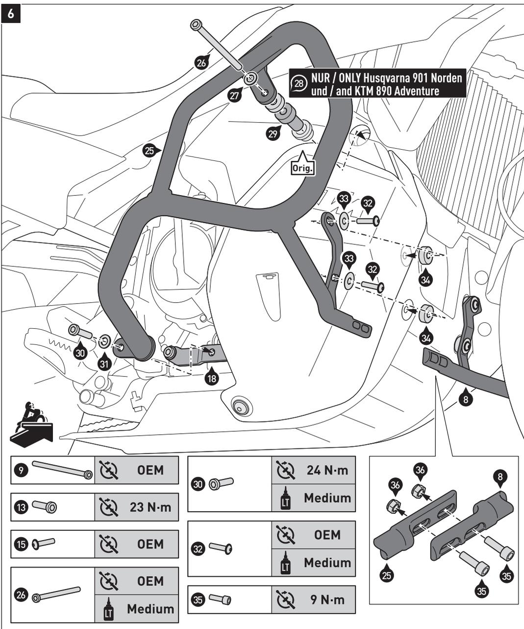
Verschrauben Sie den Sturzbügel (25) am Fahrzeug und dem Anbaublech (18). Verwenden Sie den original Gummidämpfer (Orig.) an dem oberen Anbaupunkt.
