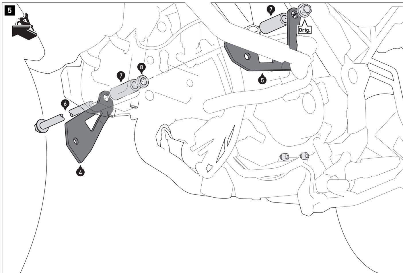
**⚠ ATTENTION :** En cas de montage simultané du crashbar SW-MOTECH, utilisez les pièces indiquées. Les crashbars se vissent sur les plaques de montage (4) et (5).
