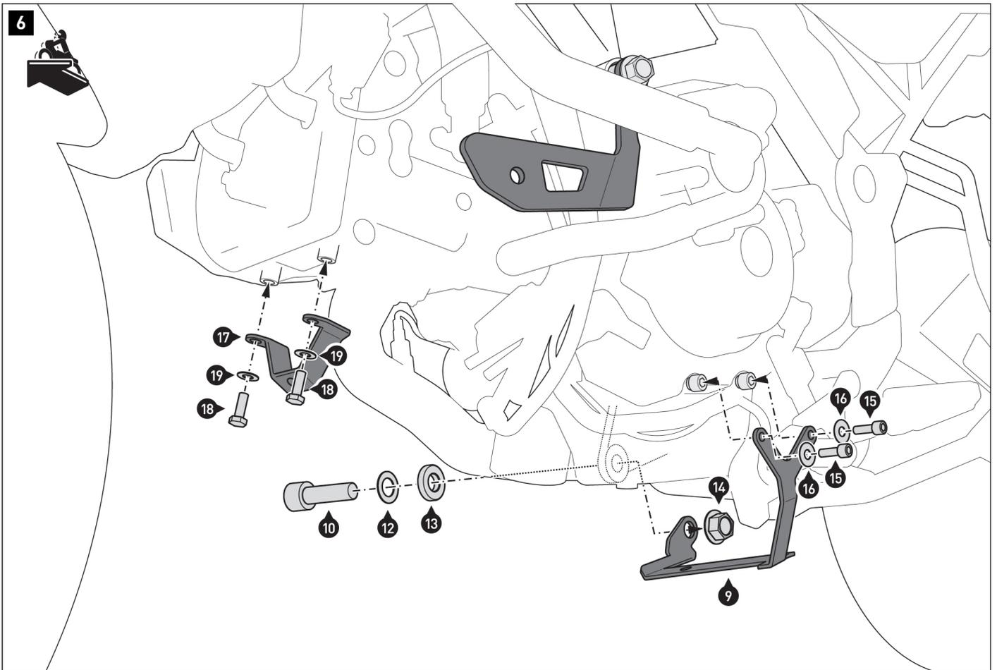
**⚠ ATTENTION :** En cas de montage simultané de la béquille centrale SW-MOTECH, utilisez la vis (11) sur le point de fixation gauche. Les éléments (12) et (13) ne sont plus utiles. Utilisez à la place les pièces de la béquille centrale.
