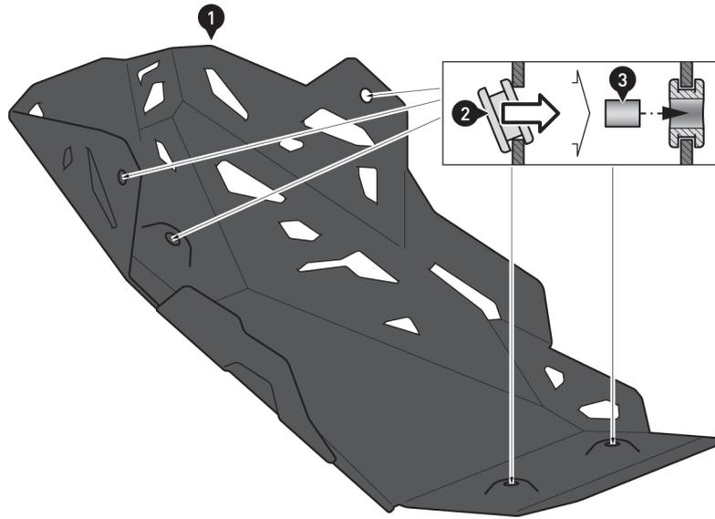
Insérez les œillets en caoutchouc (2) dans les ouvertures du sabot moteur (1).
