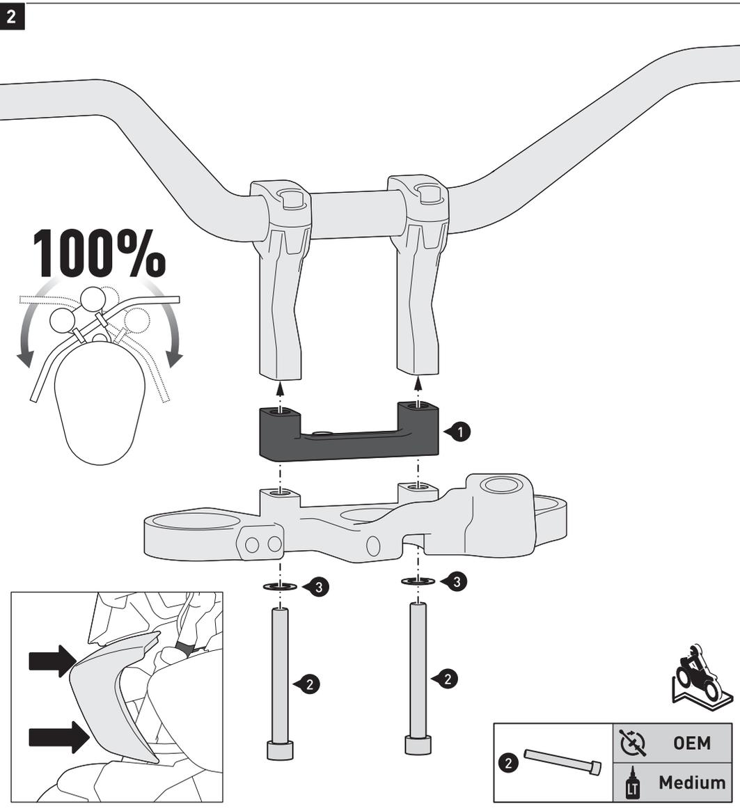
Verschrauben Sie die Lenkerhöhung zwischen den Lenkeraufnahmen und der Gabelbrücke.
