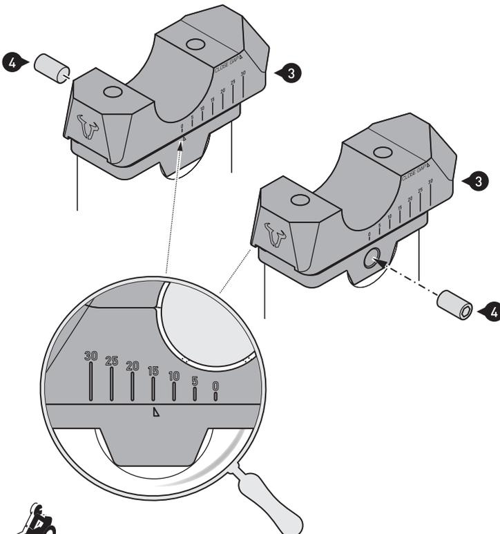
Richten Sie die Lenkeraufnahmen (3) mit Hilfe der Zahlenskalen **PARALLEL** aus.
