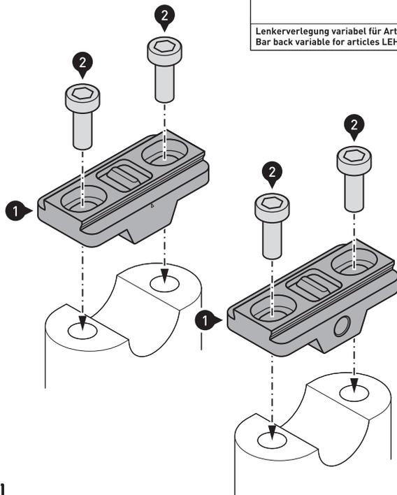
**⚠️ GEFAHR:** Achten Sie bei der Montage auf die asymmetrische Form der Basen (1) der Lenkerverlegung variabel für Ø32 Lenker (siehe Detailzeichnung)!
