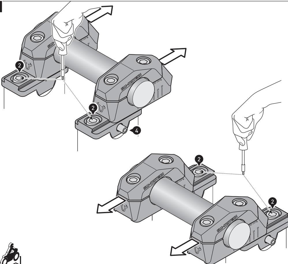
Lösen Sie die Schrauben (4).
