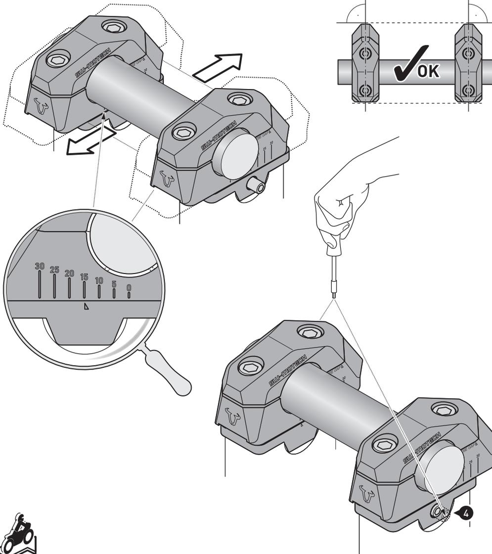
Richten Sie die Lenkeraufnahmen (3) mit Hilfe der Zahlenskalen entsprechend Ihrer Ergonomie aus. Beachten Sie dabei die unten aufgeführten **⚠ GEFAHR**-Hinweise. Achten Sie abermals darauf, die Lenkerverlegungen **PARALLEL** auszurichten. Ziehen Sie die Madenschrauben (4) wie vorgegeben an.
