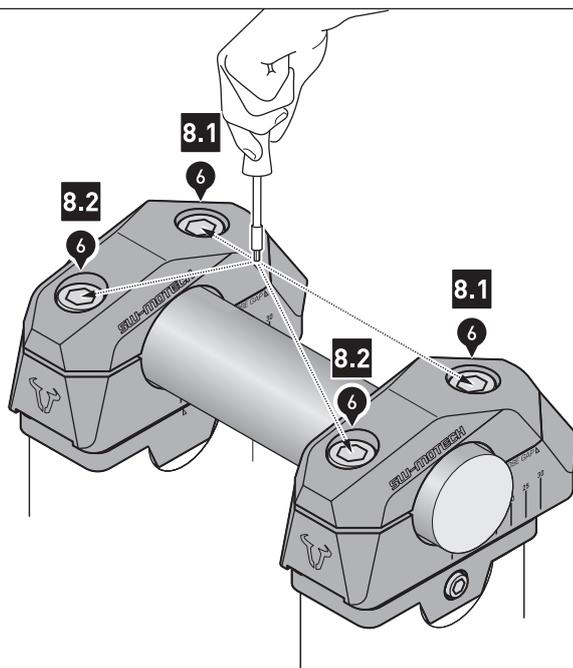
**Schritt [8.1]:** Ziehen Sie die vorderen Schrauben (6) wie vorgegeben an.
