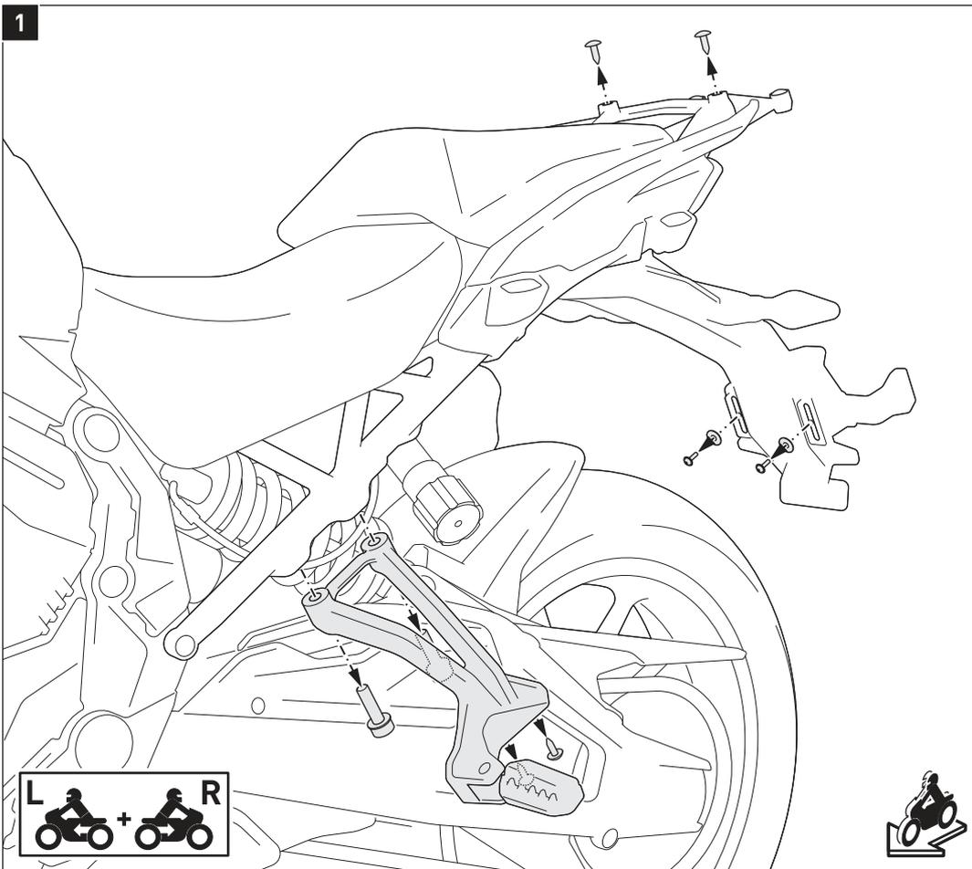
Entfernen Sie die original Schrauben, Fußrastenhalter und Kunststoffdübel **beidseitig** vom Fahrzeug.
