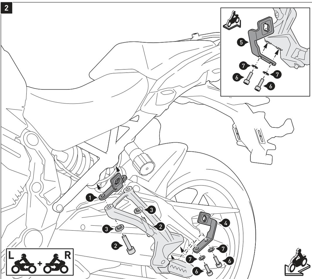
**HINWEIS:** Die Befestigungslaschen (4) und (5) sind asymmetrisch aufgebaut. Montieren Sie die Befestigungslasche (5) auf der **linken** Fahrzeugseite, wie in der Detailzeichnung gezeigt.
