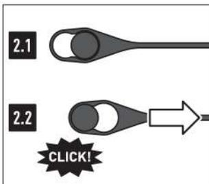
**Installation des limiteurs d'ouverture du couvercle**
