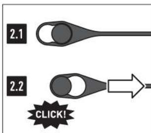
**Installation des limiteurs d'ouverture du couvercle**
