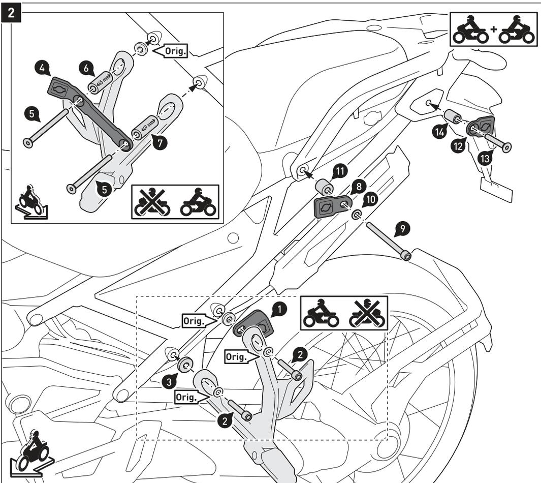
Verschrauben Sie die Befestigungstaschen (1), (4), (8) und (12) **beidseitig** mit den gezeigten original Unterlegscheiben und Buchsen (Orig.) am Fahrzeug.
