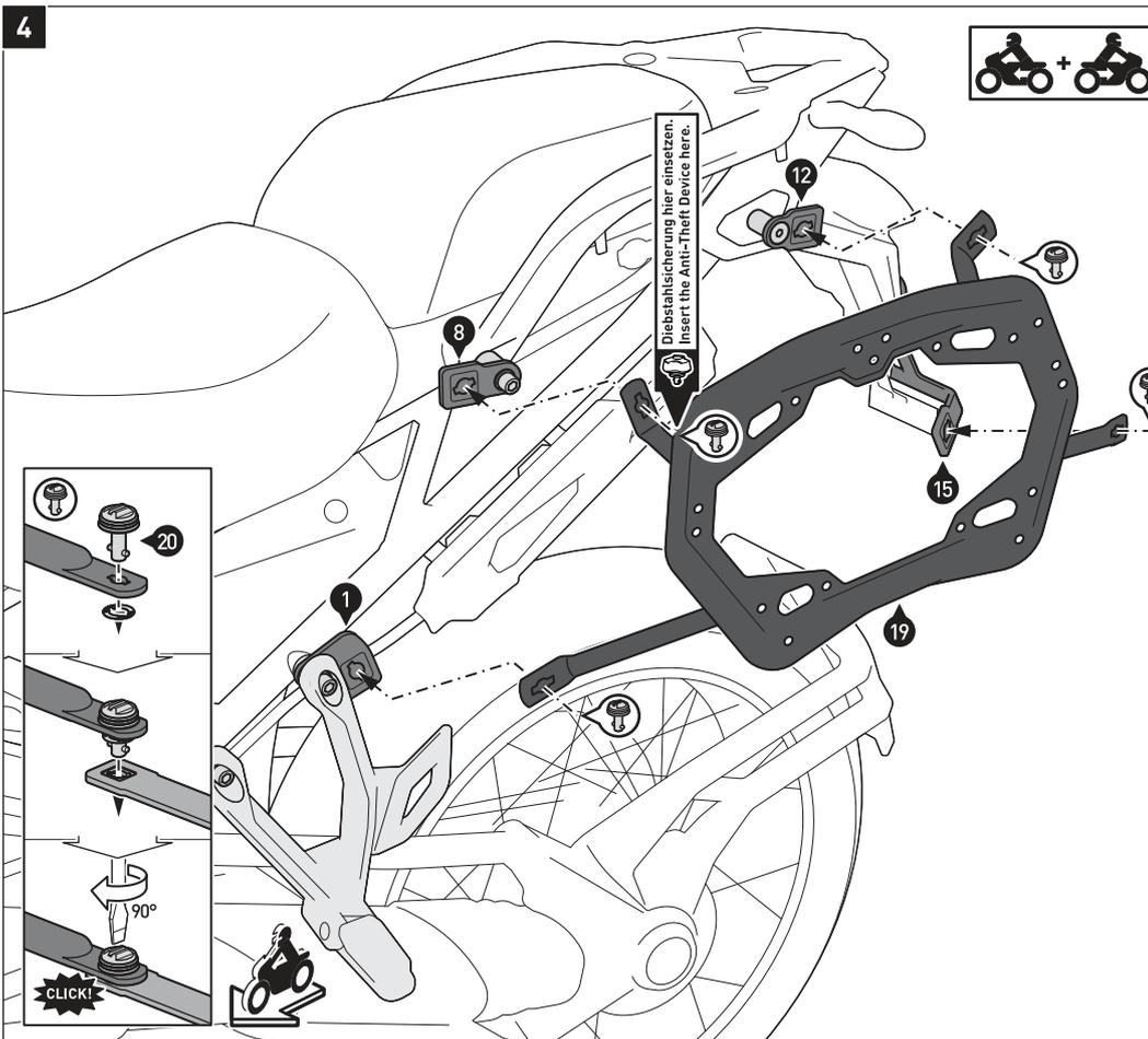
Verbinden Sie die Seitenträger (19) mit den Schnellverschlüssen (20) an den Befestigungslaschen (1), (4), (8) und (12) und dem Querverbinder (15). Sichern Sie die Schnellverschlüsse mit den Sicherungsscheiben.
