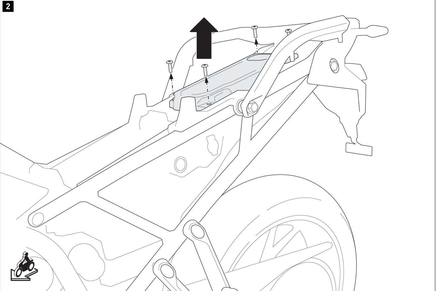
Retirez les vis indiquées, desserrez le connecteur et retirez l'unité de commande avec le cache de la moto.
