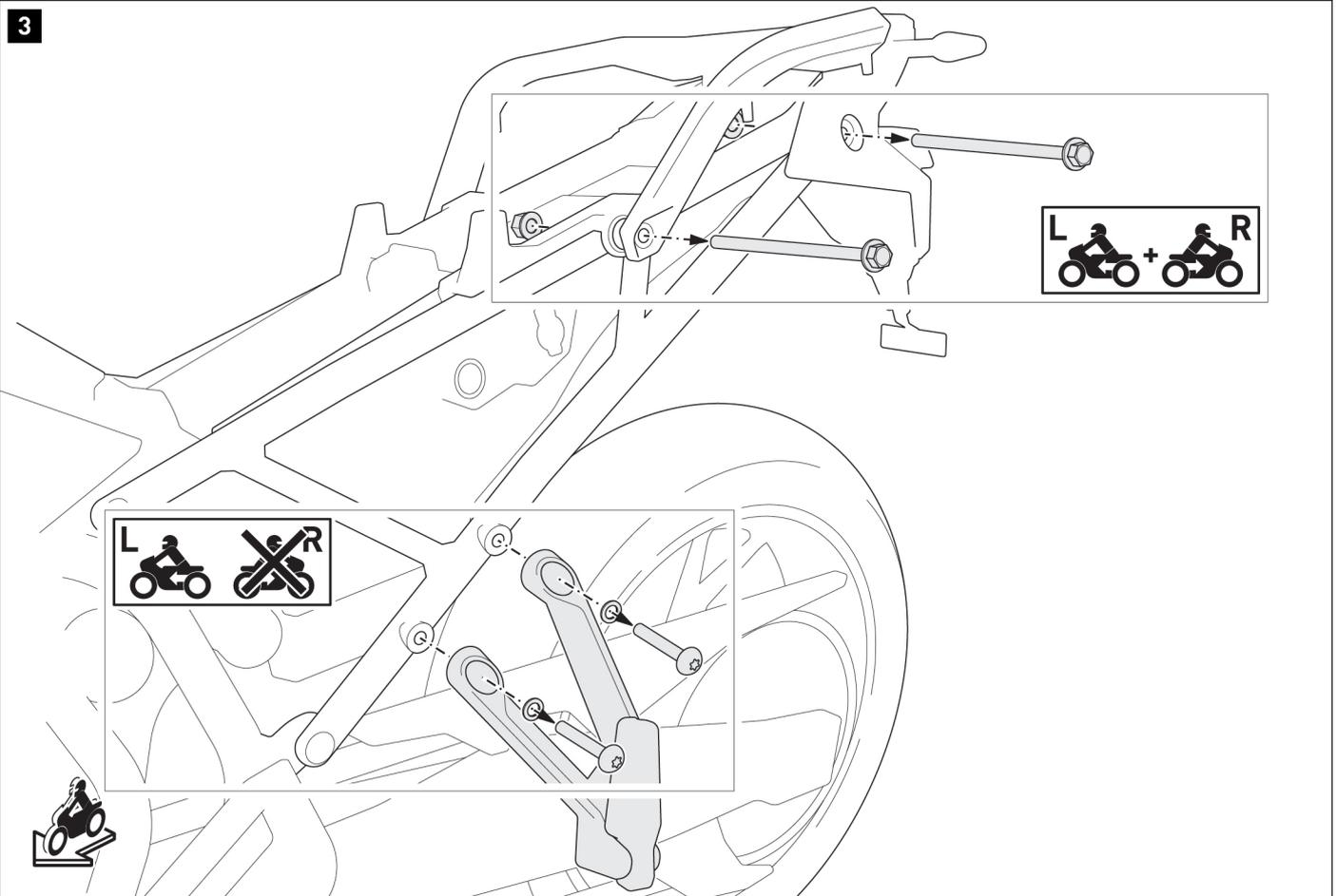
Retirez les vis et les écrous indiqués des deux côtés de l'arrière de la moto.
