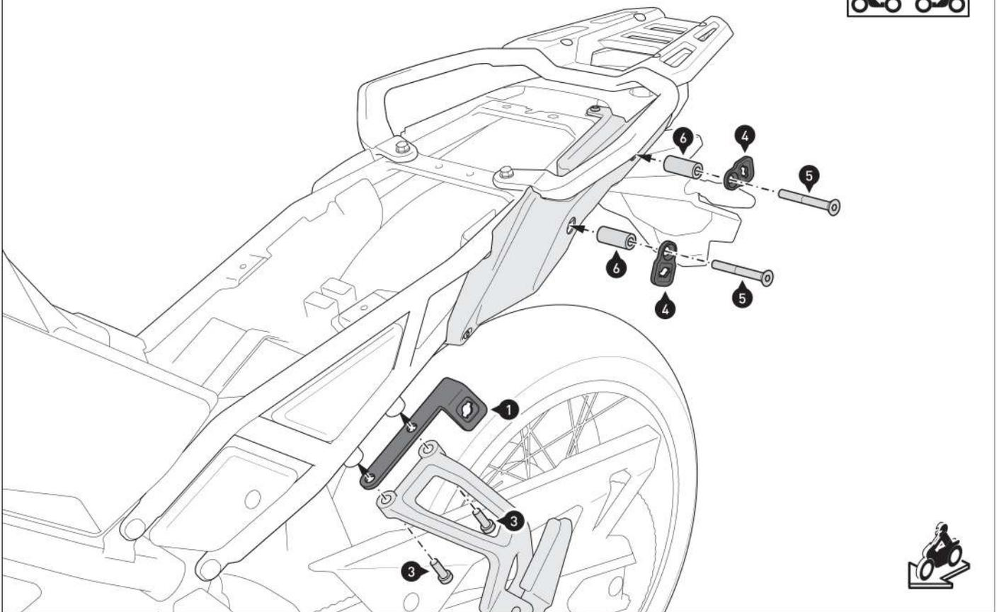
Vissez les pattes de fixation (1/2) et (4) **des deux côtés** du véhicule.
