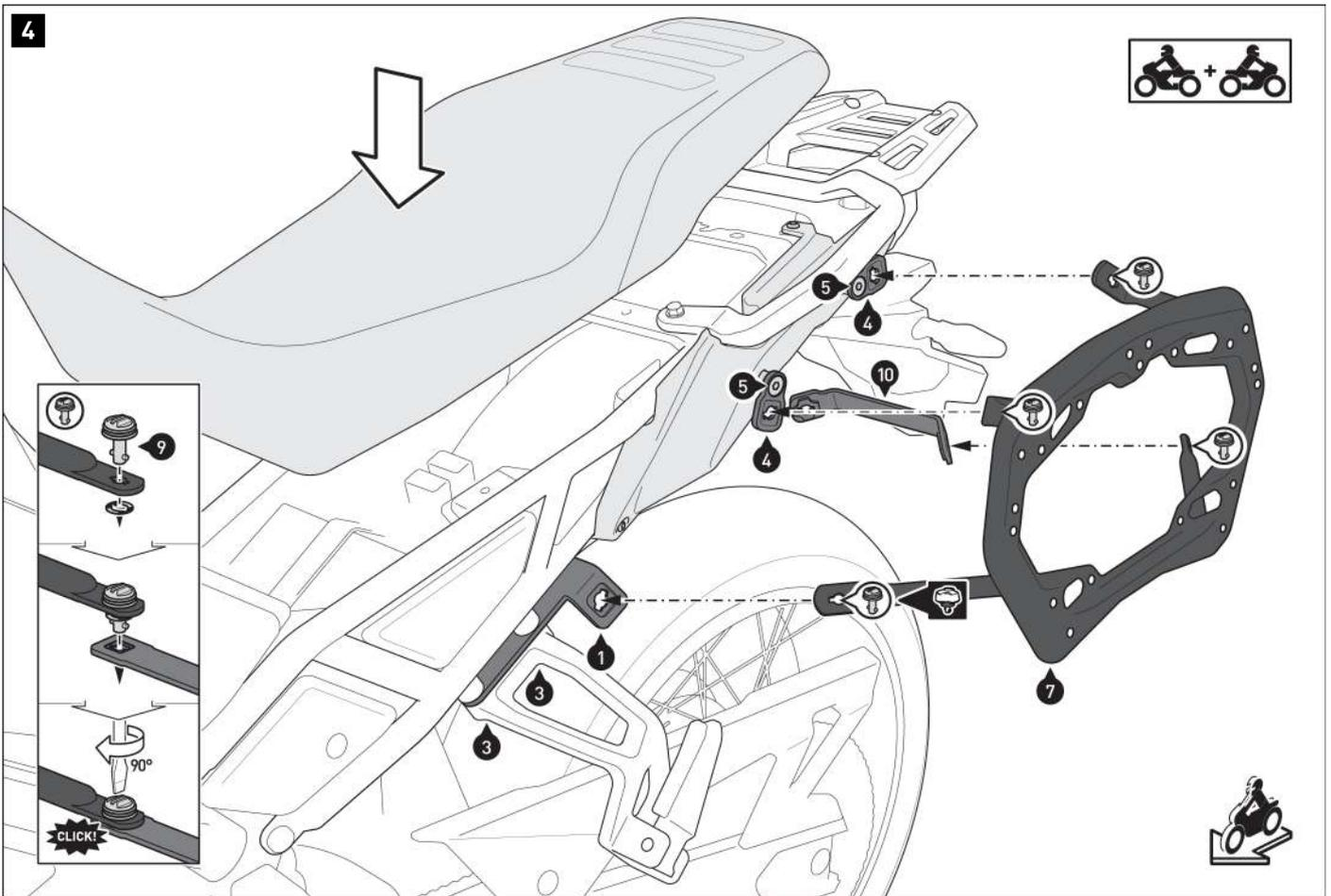
Reliez les supports latéraux (7/8) **des deux côtés** avec les verrouillages rapides (9) sur les pattes de fixation (1/2) et (4), ainsi que la barre de jonction (10). Fixez les verrouillages rapides avec les rondelles de sécurité.
