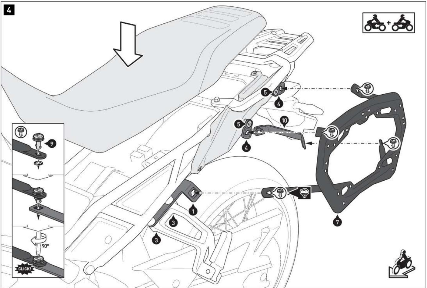
Reliez les supports latéraux (7/8) **des deux côtés** avec les verrouillages rapides (9) sur les pattes de fixation (1/2) et (4), ainsi que la barre de jonction (10). Fixez les verrouillages rapides avec les rondelles de sécurité (4).
