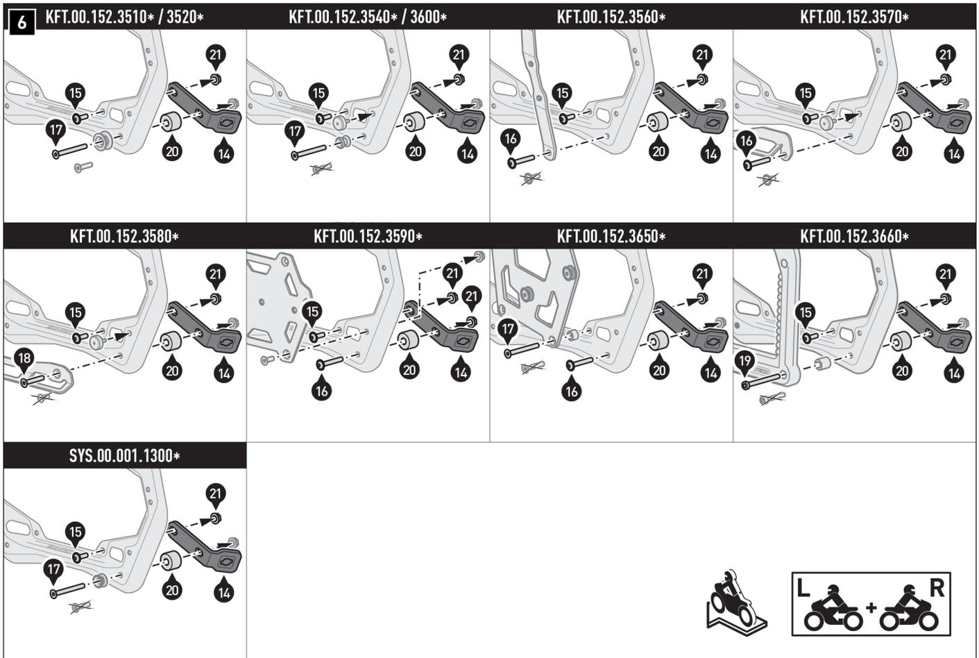
Vissez les pattes de fixation (14) avec les pièces de montage prévues pour votre kit d'adaptation SW-MOTECH aux points de montage indiqués sur les supports latéraux (11/12).
