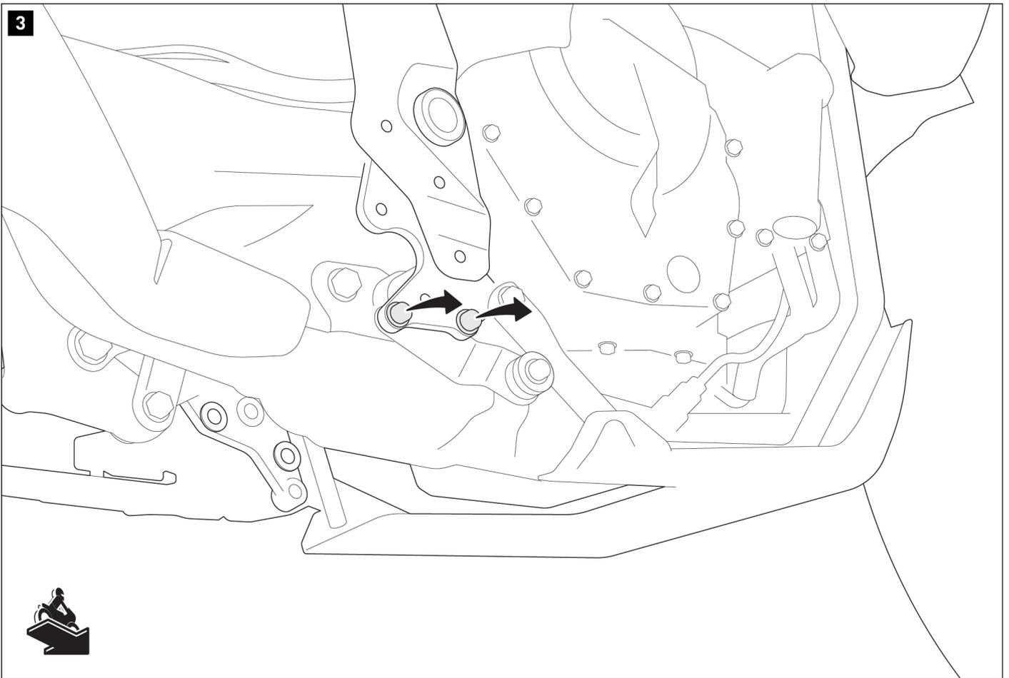
Retirez les deux vis indiquées du véhicule (replier simplement le repose-pieds).
