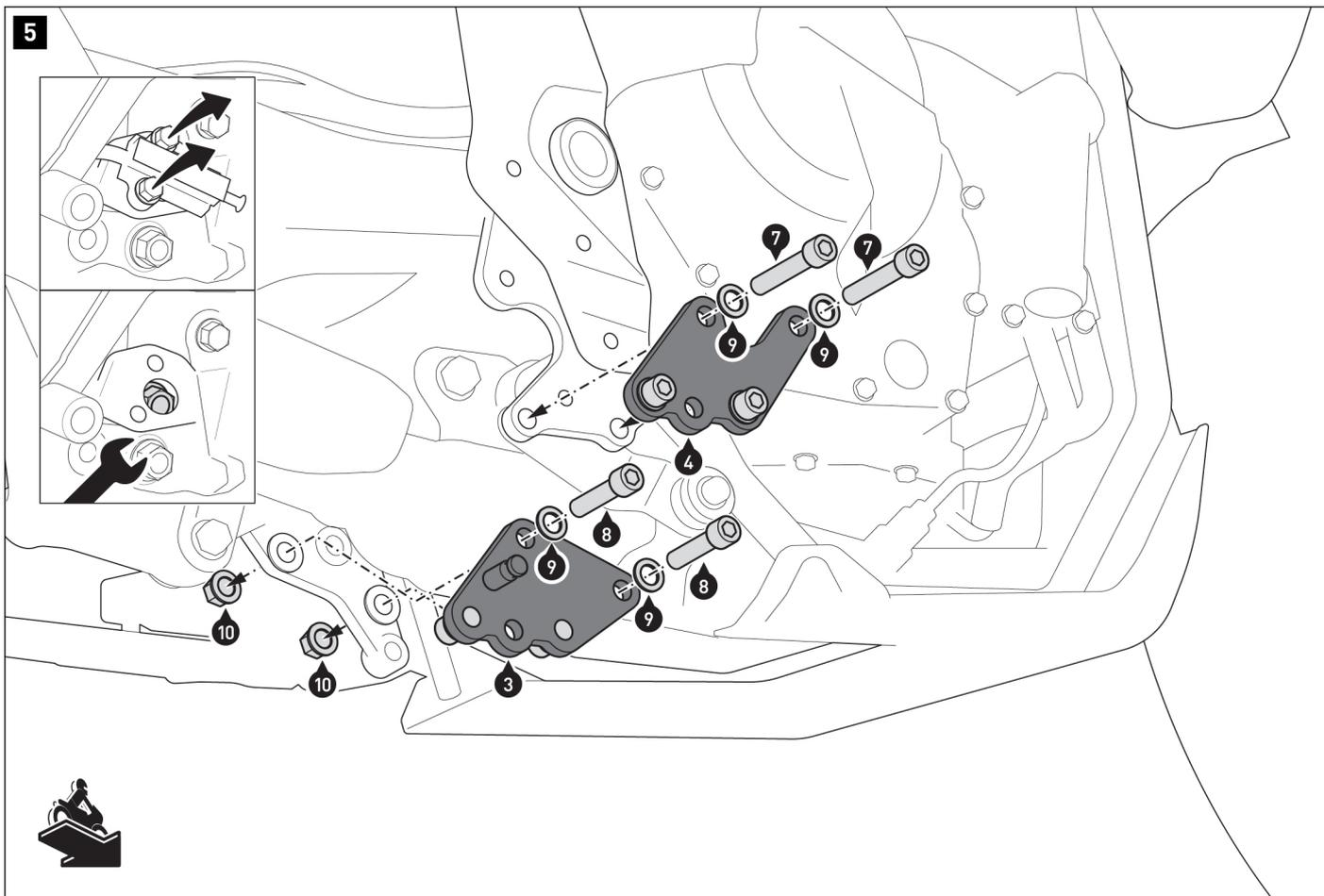
Desserrez le capteur de béquille latérale sur le côté gauche du véhicule pour pouvoir mieux installer l'écrou (10).
