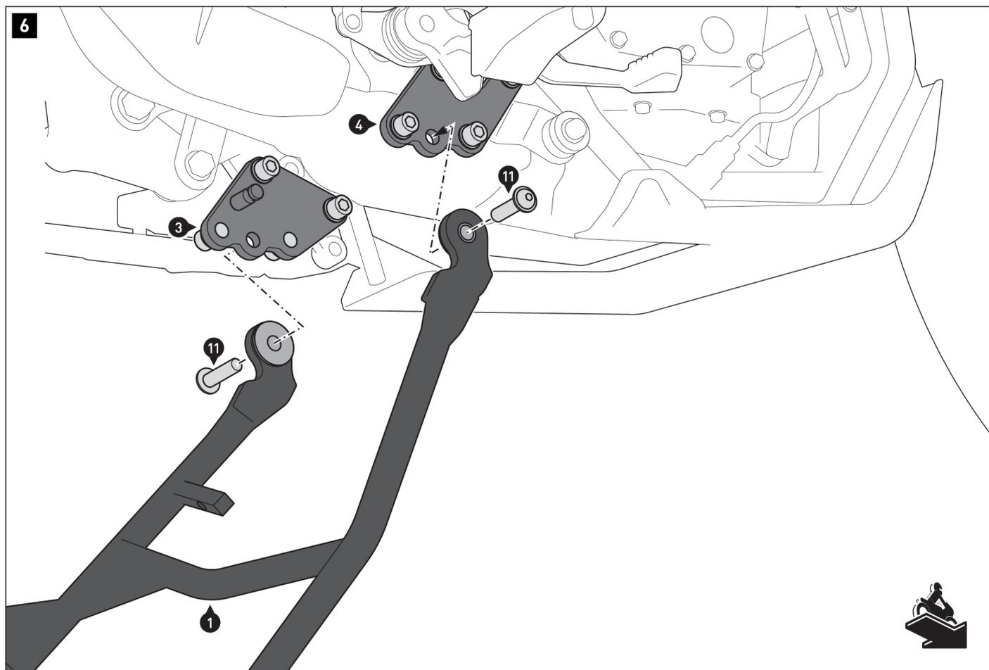
Revisser les éléments démontés lors des **étapes [1] et [2]** sur le véhicule en respectant toutes les instructions du constructeur.
