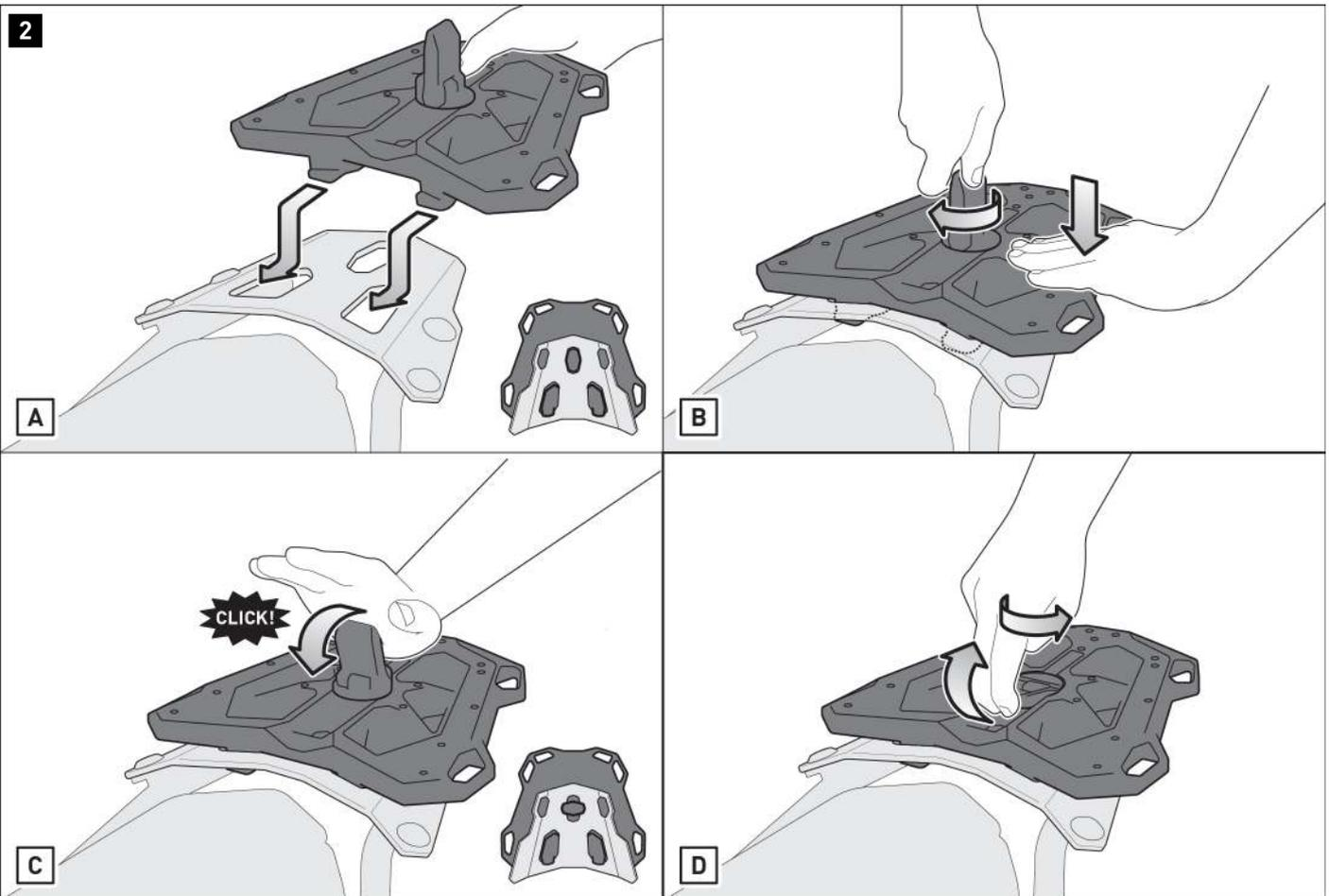
**Illustration [A]** : insérez la platine d'adaptation (1) avec ses deux crochets dans les ouvertures de votre porte-bagages STREET-RACK (vendu séparément).
