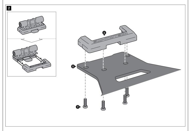
$\triangle$  **REMARQUE :** Le cadre de fixation (6) et le cadre d'insertion (2) sont livrés emboîtés l'un dans l'autre !
