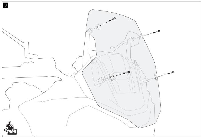
Dévissez les vis et retirez le pare-brise du véhicule.
