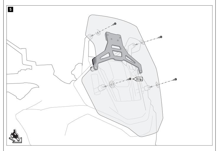
Revissez le pare-brise sur le véhicule à l'aide des vis d'origine (Orig.).
