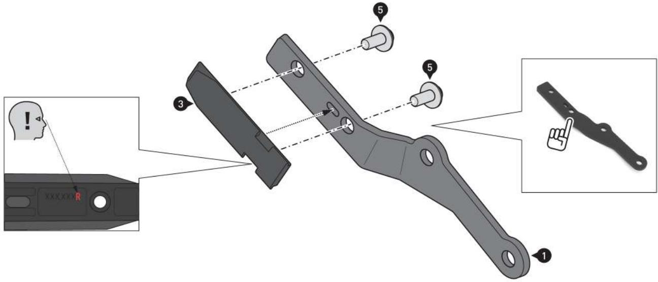
**⚠ REMARQUE :** Visser les rails de montage des connecteurs (3/4) sur le côté des supports de fixation (1/2) indiqué sur le schéma.
