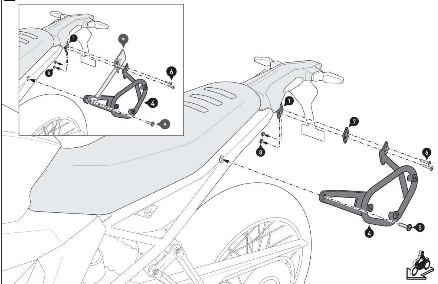
**▲ REMARQUE :** si l'est installé en même temps que le porte-bagages SW-MOTECH (\*), vissez les pièces ensemble comme indiqué sur le dessin détaillé. L'entretoise (7) et la vis (5) ne sont plus nécessaires. À leur place, installez la vis (\*) fournie avec le support valises.
