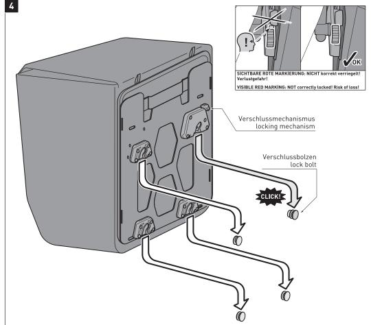
Setzen Sie die Arretierungsöffnungen des Verschlussmechanismus und der Arretierungsaufnahme auf die Führungsbolzen des Adapterkit für SysBag (separat erhältlich).
