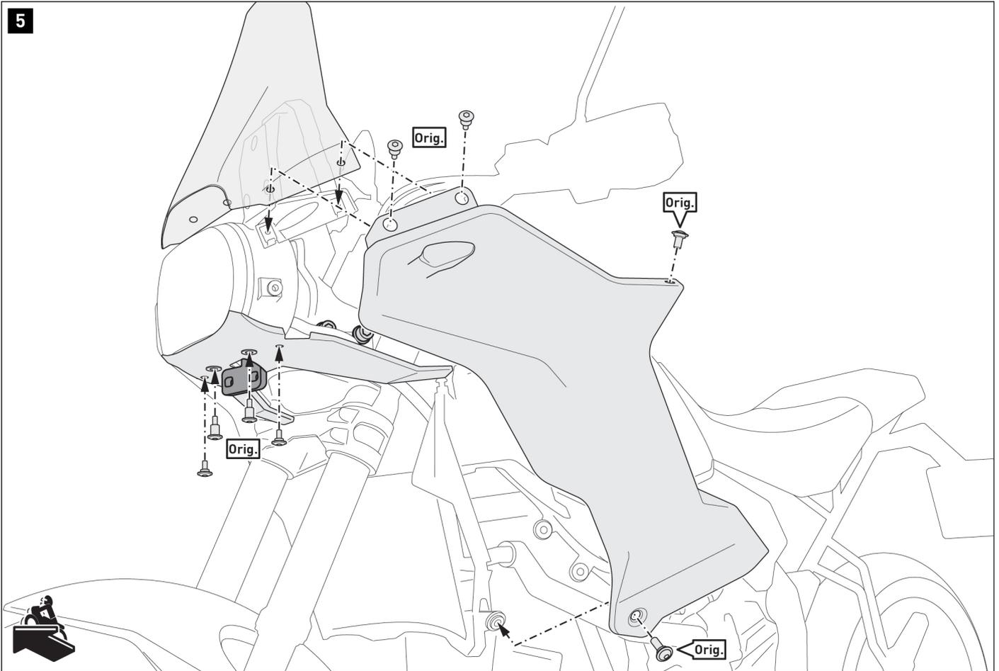
Remontez les panneaux précédemment démontés sur le véhicule.
