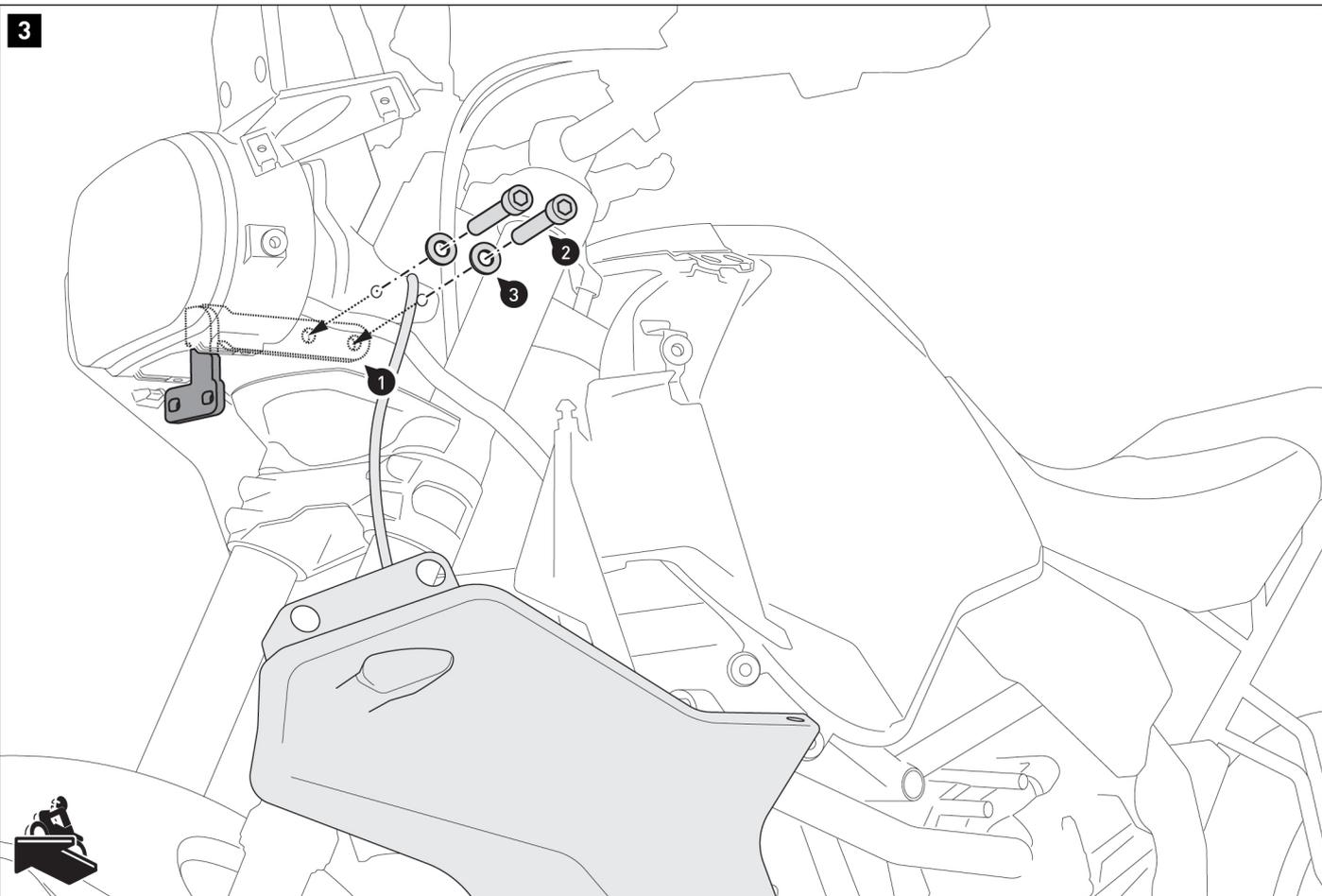
Vissez le support de fixation [1] sur le côté gauche du véhicule, sur le côté intérieur de la colonne de direction.
