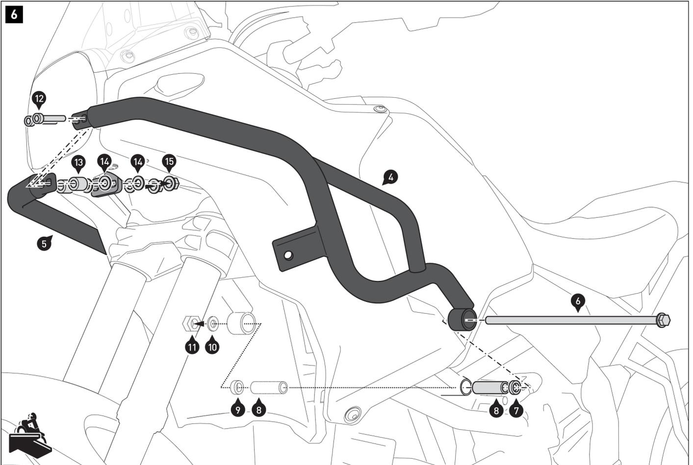
**REMARQUE** : en cas de montage simultané du crashbar et du sabot moteur SW MOTECH, les entretoises (7) et (9) ne sont pas nécessaires.
