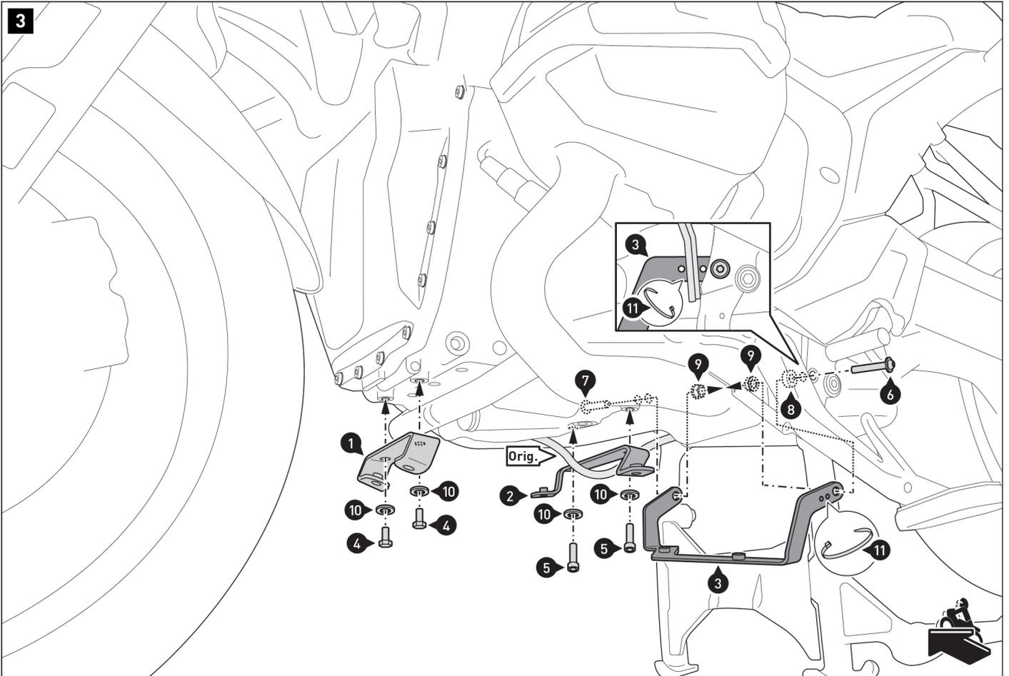
Vissez la plaque de montage avant (1), la plaque de montage centrale (2) et la plaque de montage arrière (3) au véhicule.
