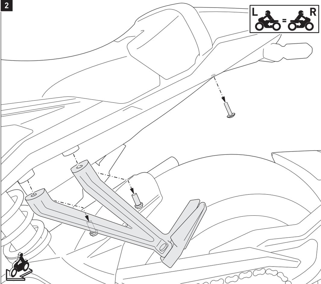
Entfernen Sie die gezeigten Schrauben vom Fahrzeug.
