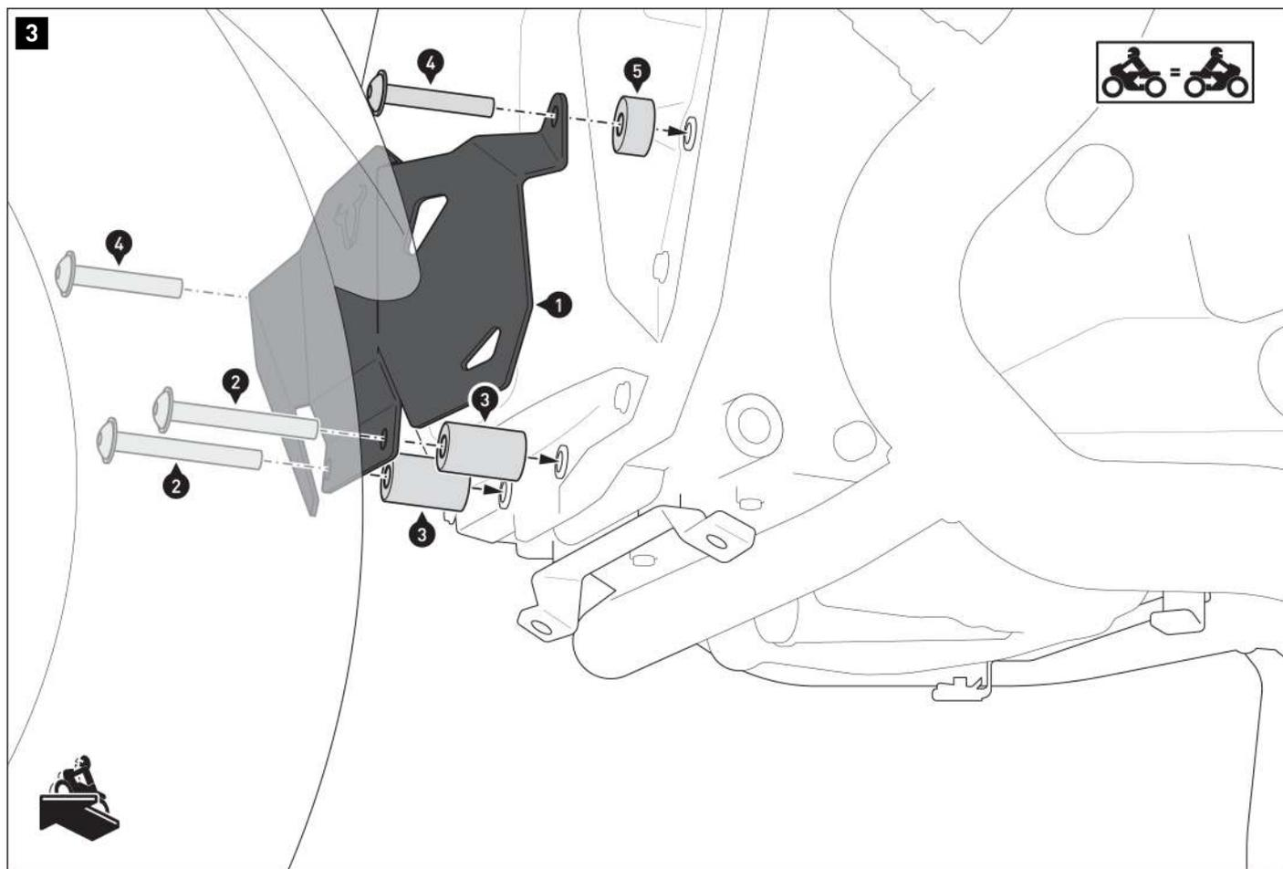
Vissez l'extension avant de sabot moteur (1) sur le véhicule.
