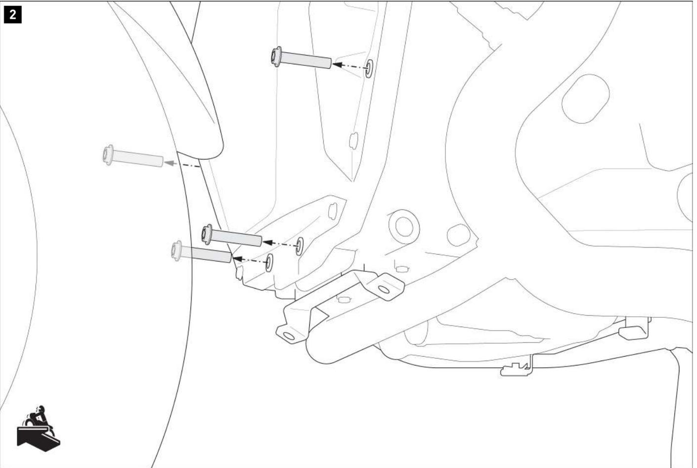
Retirez les quatre vis d'origine indiquées du véhicule.
