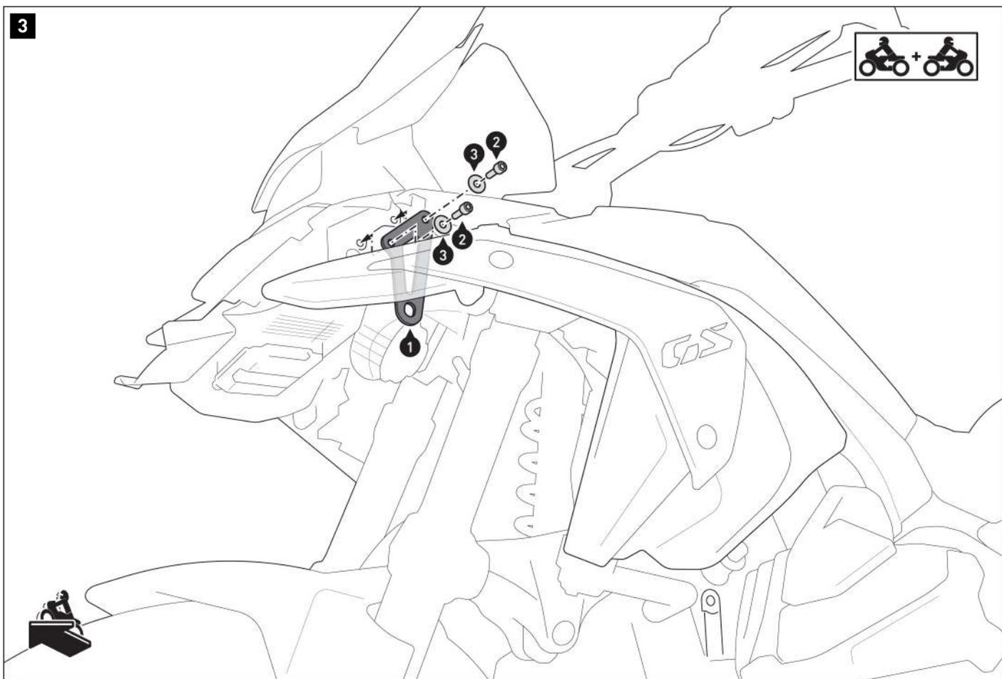
Vissez les plaques de montage (1) des deux côtés du véhicule. Assurez-vous de faire passer les câbles situés aux points de montage au-delà des plaques de montage à l'intérieur.
