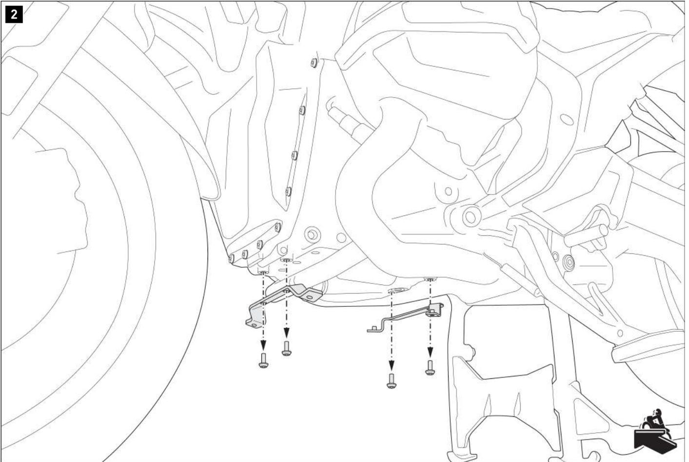
Retirez les plaques de maintien d'origine du véhicule.
