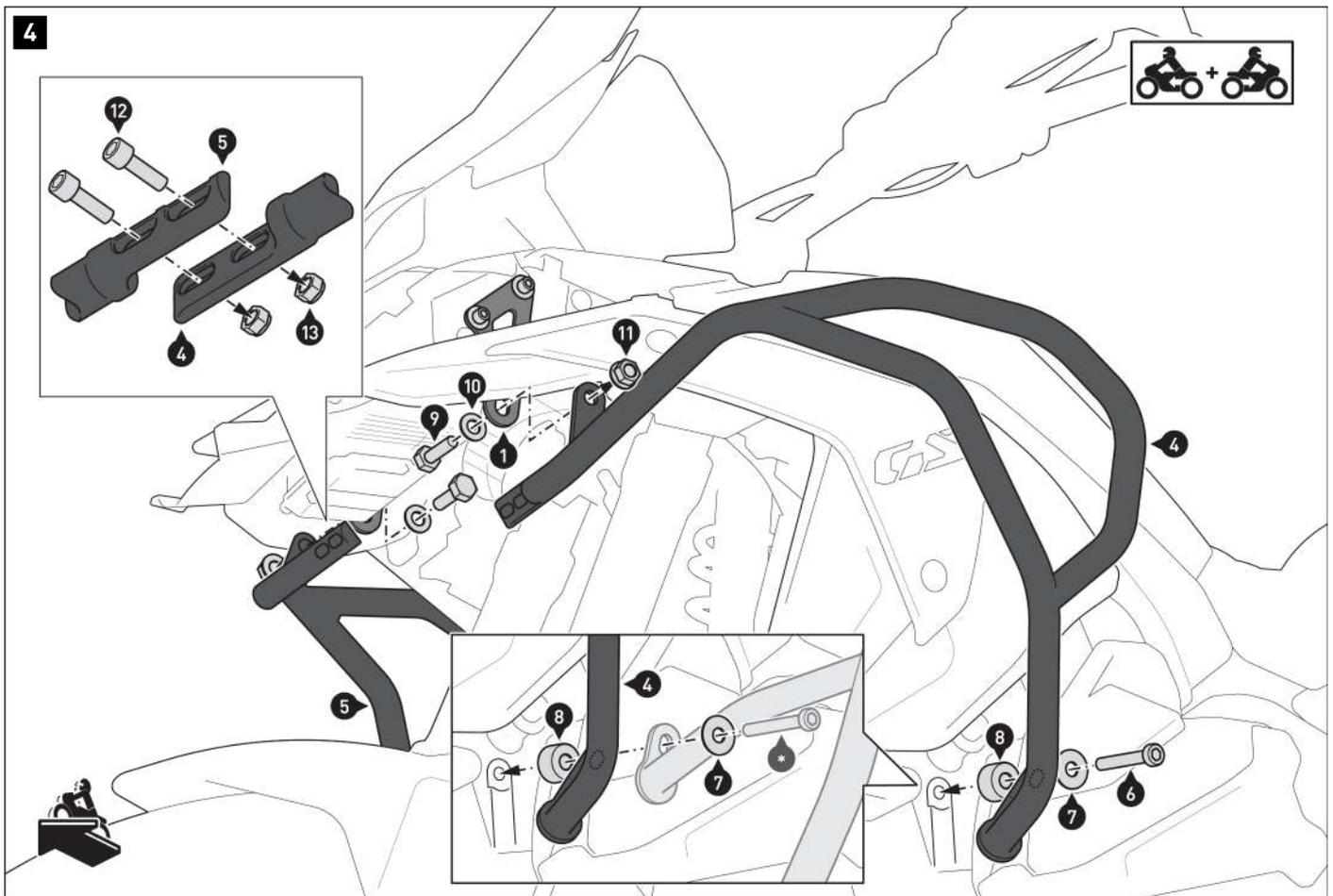
**⚠ REMARQUE :** si ce produit doit être installé avec le crashbar SW-MOTECH, le montage au niveau du point de fixation inférieur est modifié (voir schéma détaillé ci-dessous). Utilisez les vis (\*) fournies avec le crashbar.
