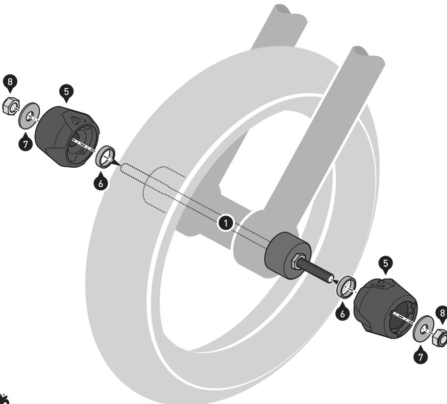
Montieren Sie die Sturz pads (5) mit den Muttern (8) **beidseitig** an der Gewindestange (1).
